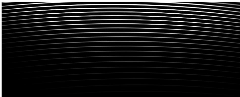
L'identification automatique des ordres nécessite une spectre continu, ici le spectre d'une lampe à incandescence halogène (tungstène). Ce même spectre donne aussi accès à la fonction de *blaze*, qui indique comment l'instrument répond à la lumière le long d'un ordre donné.
