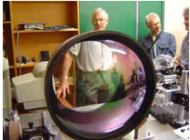
600 mm diameter Subaru corrector.
